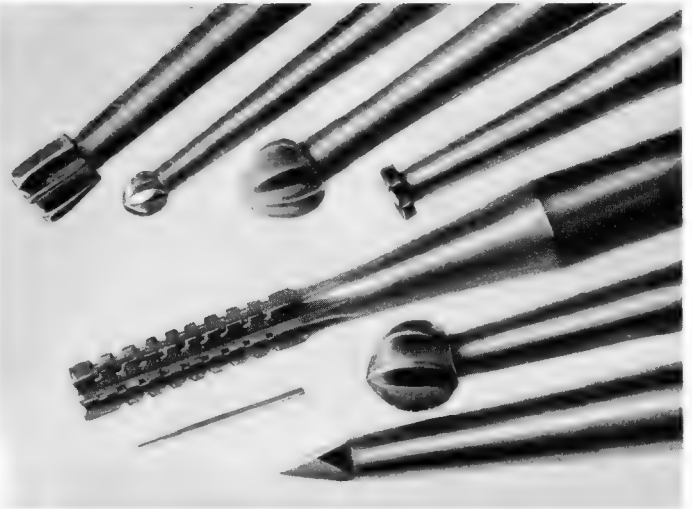
Bild 1. Eine Reihe verschiedener Bohrerarten in stark vergrößerter Darstellung; links unten ein Bohrer in halber natürlicher Größe
