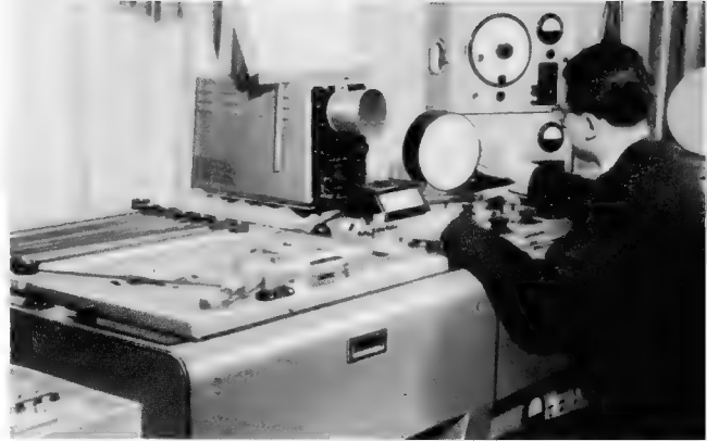
Bild 1. Der Techniker Heinz Schütz produziert Klänge nach den akustischen Daten der Partitur. Das Bild zeigt Mischpult, Magnetophon, Oszillograf (links) und Tongenerator (rechts)
